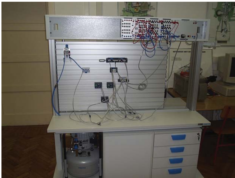
Slika 1. Mobilna radna stanica za pneumatiku
