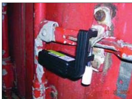
Slika 5. RFID transponder na vratima kontejnera
